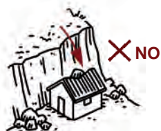
X NO No construir en barrancos ni zonas de derrumbe.
