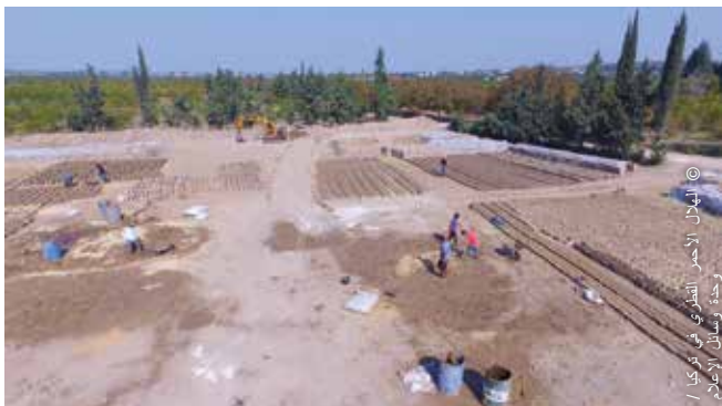
ويتطلب إنتاج الطوب النية مساحات كبيرة جداً ولا يمكن تنفيذ هذه العملية إلا خلال موسم الجفاف فحسب. وتسببت هذه العملية في حدوث بعض الصعوبات في عملية التنفيذ.
