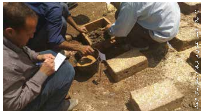
أجري تدريب المدربين لموظفي الشركاء المحليين في سوريا. وتكون هذا التدريب من وحدة قائمة على الفقة واختيارات عملية في هذا المجال، مثل اختبار الطوب المصنوع من أخلاط مختلفة وتحليل عينات مختلفة من التربة.
